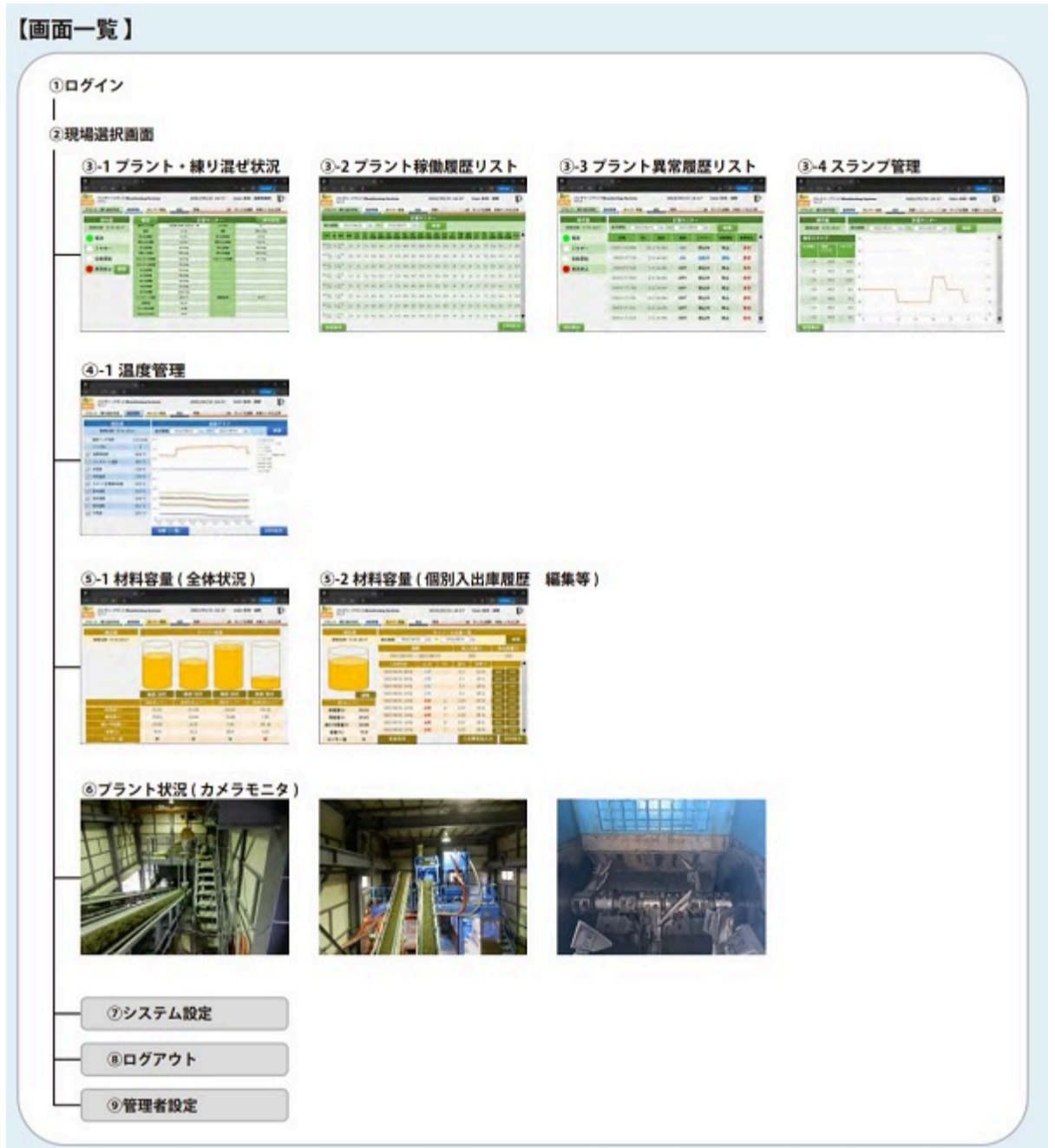
吹付プラント遠隔管理システム「DMAX」の表示画面
